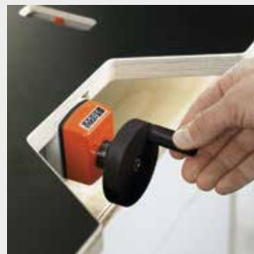
Grâce au lecteur digital et la manivelle, la mesure de perçage nécessaire peut être ajustée facilement et avec précision.
